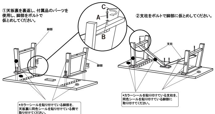
③全てのパーツを仮とめ取付を完了後、ボルトを本締め してください。各部分がしっかり固定されていることを確認
