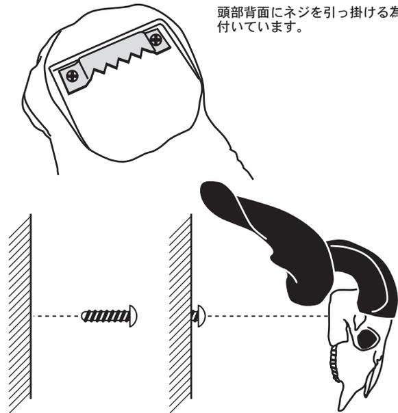
取り付ける壁面に木ネジを打ち込みます。その際、2~3ミリ程度ネジを残して下さい。本体を壁に取り付けるためのネジは付属しておりません。
