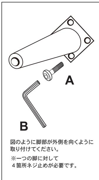
図のように脚部が外側を向くように取り付けてください。
